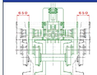
ロータは、左右各 650 mm までシフトが可能です。障害物があっても最小限のロータシフトだけで作業ができます。
