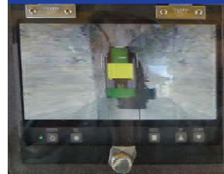
全方向視界(360度)の見やすい上空視点で表示。オペレータの安全確認をひと目でサポートします。またカメラは切替が可能です。
