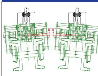
本体に対して左右各5度傾くチルト機構を搭載しています。
