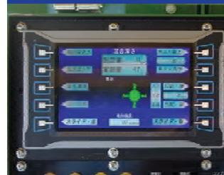
運転席のフルカラーディスプレイには、混合深さ自動制御システムの設定・表示のほか、速度表示や各種表示、各種作業設定が行えます。
